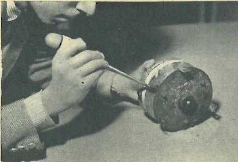
Il porta-specchio è costituito di due dischi, uno di legno ed uno di metallo. Il bottone nel centro serve per sorreggerlo nel montaggio. Il portaprisma è un tripode regolabile; l'oculare è mantenuto su una piastra ed un tassello di legno raccordato al tubo.
